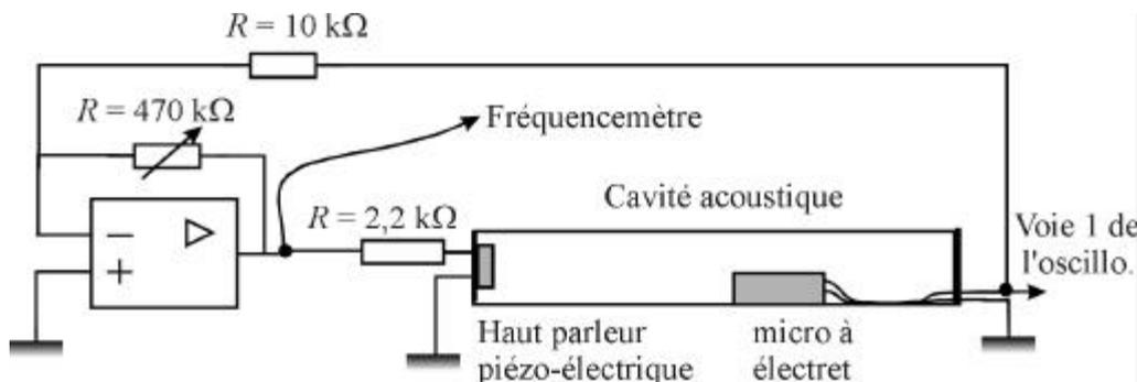
Réaliser le montage proposé et augmenter lentement la valeur du gain de l'amplificateur jusqu'à ce que vous constatiez que le système oscille ( $G \approx 20$ ). Déplacer le micro à l'intérieur de la cavité (en tirant doucement sur les fils de liaison), relever les fréquences d'oscillation observées et comparez les à celles obtenues dans l'étude de la cavité résonnante seule.
