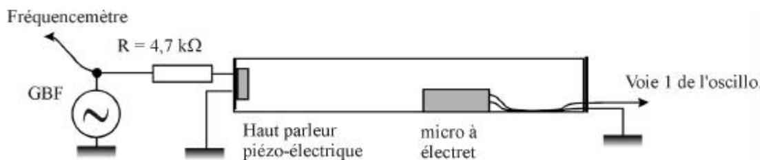
On pourra relever l'amplitude et la fréquence des ondes qui s'établissent dans la cavité.
